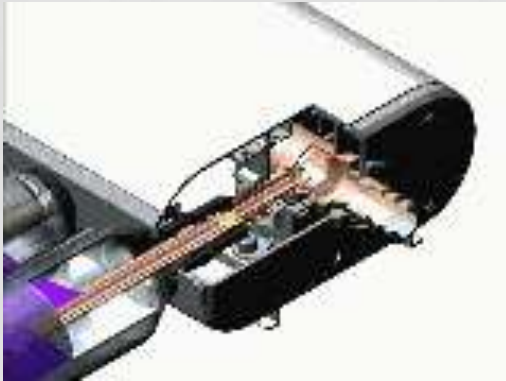
Vue en coupe capteur sous vide
