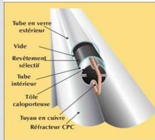
Vue en coupe capteur sous vide
