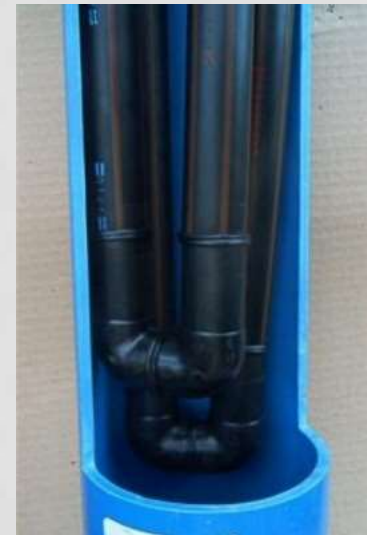
Sonde géothermique: tuyaux PET haute densité de 32 mm de diamètre et 2.9 mm d'épaisseur pour une pression de 16 bars
