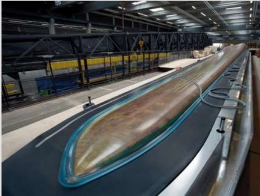
Moulage d'une pale d'éolienne Siemens
