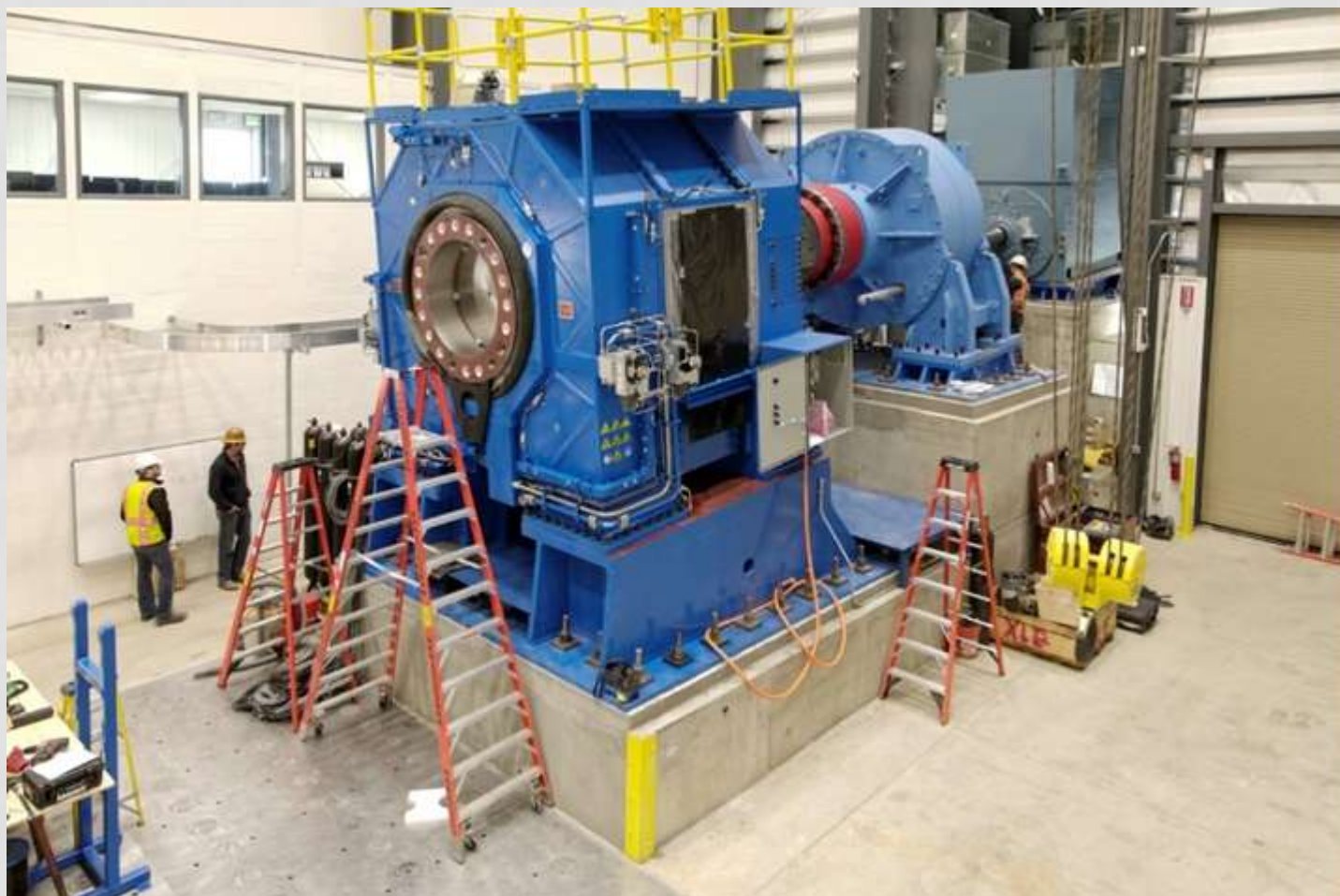
Test d'une turbine de 5 MW
