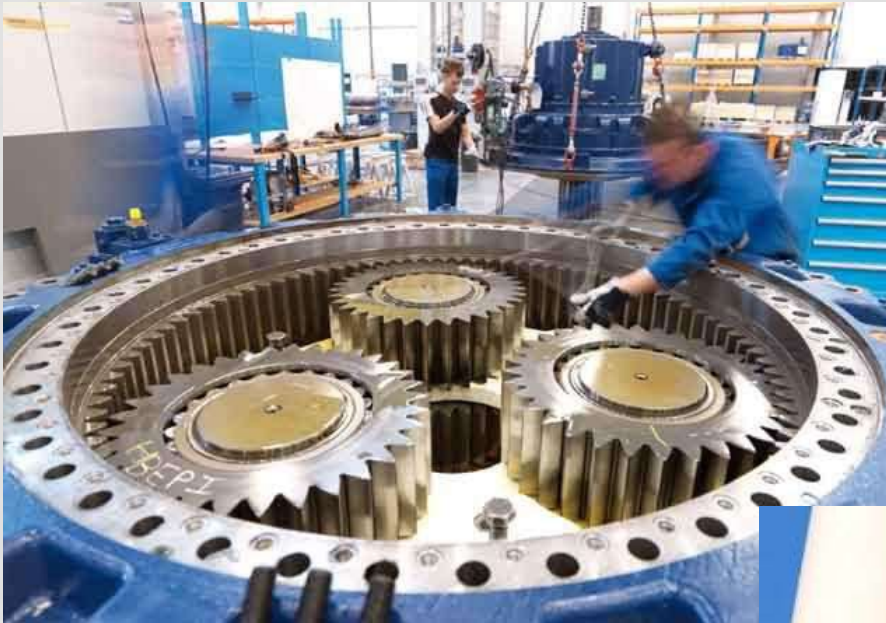
Remplacement de la boîte de vitesse
