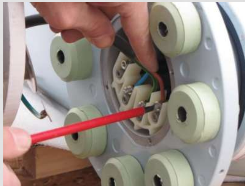
POSE DES SILENTBLOCS ET FIXATION DU CÂBLE À LA GÉNÉRATRICE
