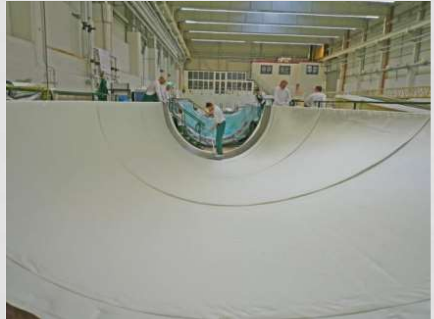
Moulage d'une pale d'éolienne Siemens
